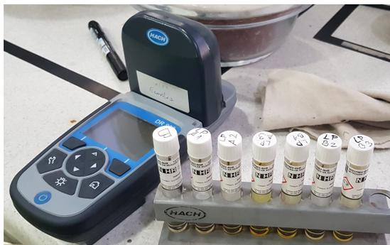
Figura 3.2: Equipo DR-900, junto a las muestras analizadas.
