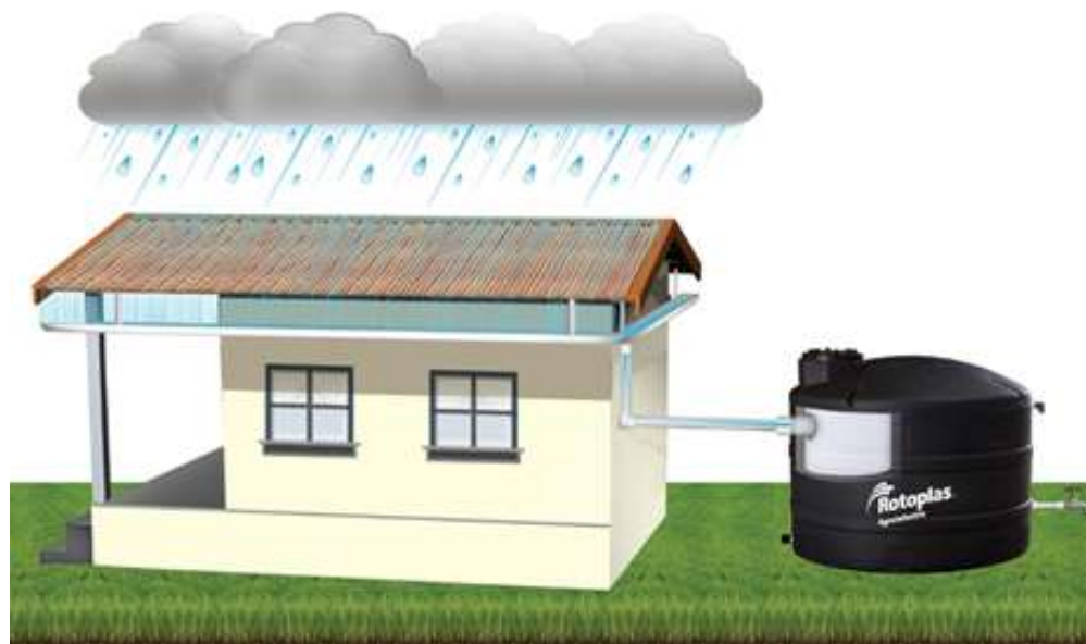
Figura 3: Esquema conceptual de un sistema de recolección de agua lluvia.
