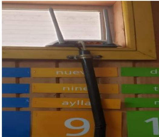
Figura 2.2: Router configurado como punto de acceso en la sala de computación.
