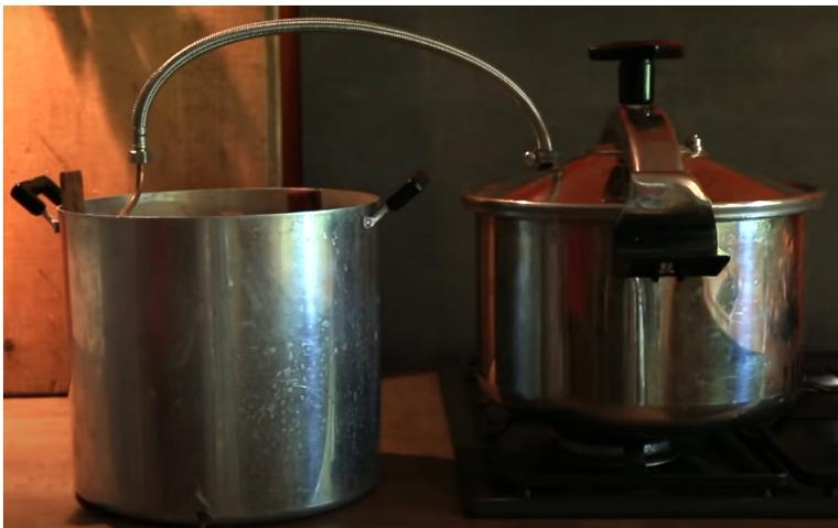
Figura 1: Ejemplo de sistema construido para hidrodestilación de plantas para obtención de aceites esenciales. A la derecha se observa olla a presión y a la izquierda contenedor con serpentín. [17].
