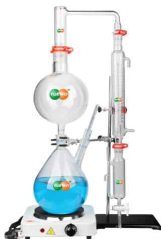
Figura E.4: Kit de hidrodestilación de laboratorio para elaboración de aceites esenciales [18].
